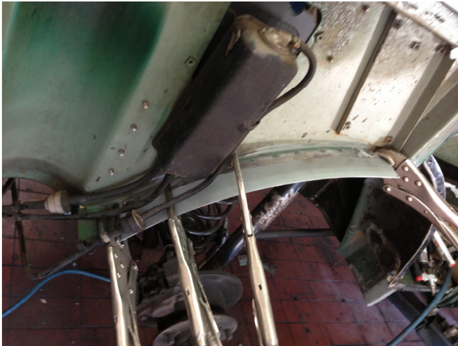
Hier wird der das neu gefertigte Blech angepasst
