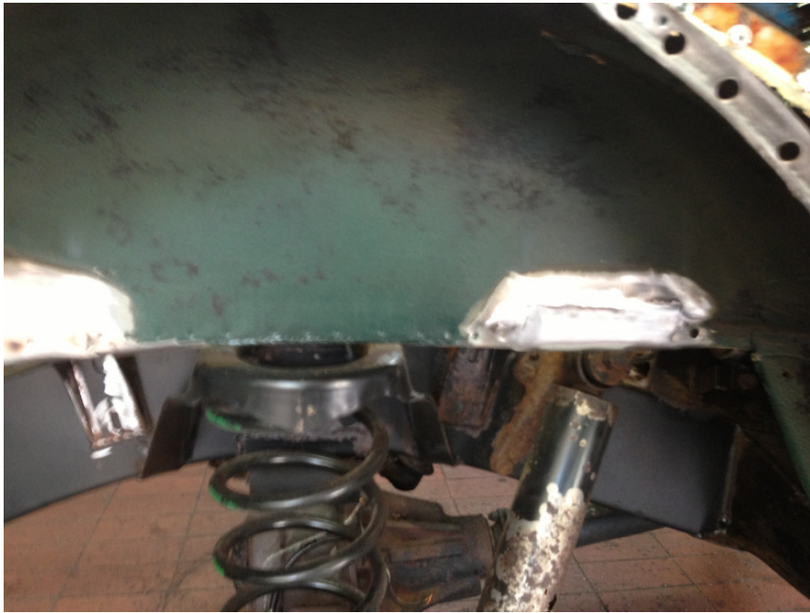
Nachdem sauber zugeschweißt ist kann der komplette Boden versiegelt werden
