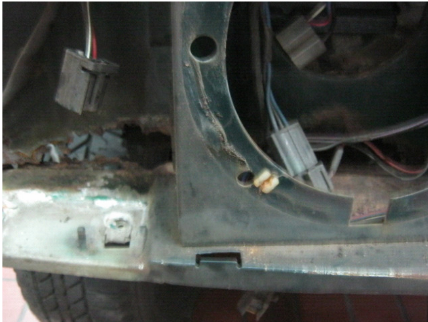
Durchrostungen am Lampenkasten
