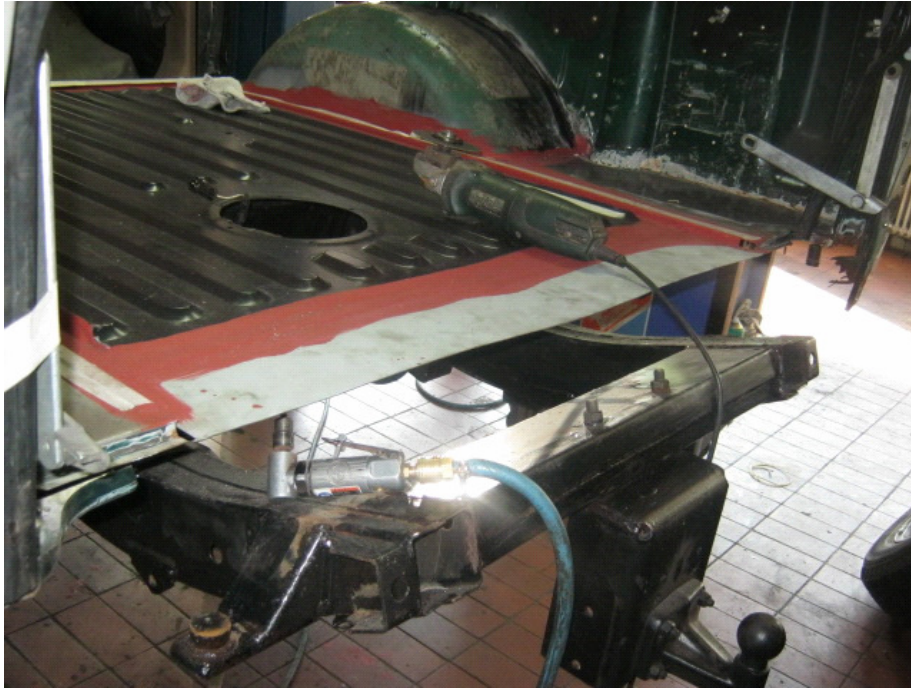
Hier ist der neue Boden sauber eingebaut
